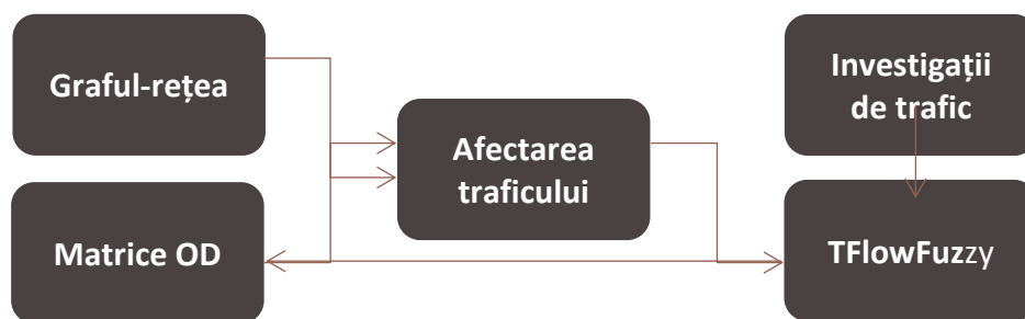
Figură 3-21 Schemă a logică a procesului de calibrare utilizat
